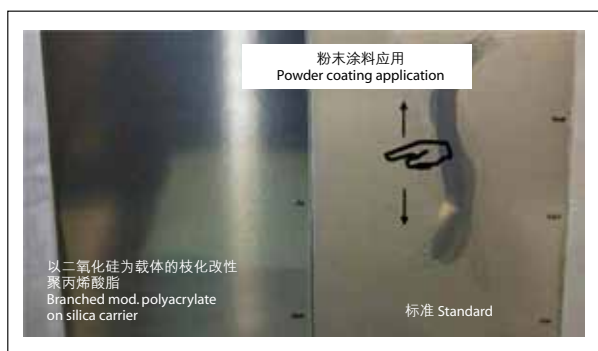
图5: 以二氧化硅为载体的枝化改性聚丙烯酸酯, 100%固体添加剂的「抗雾」效果
