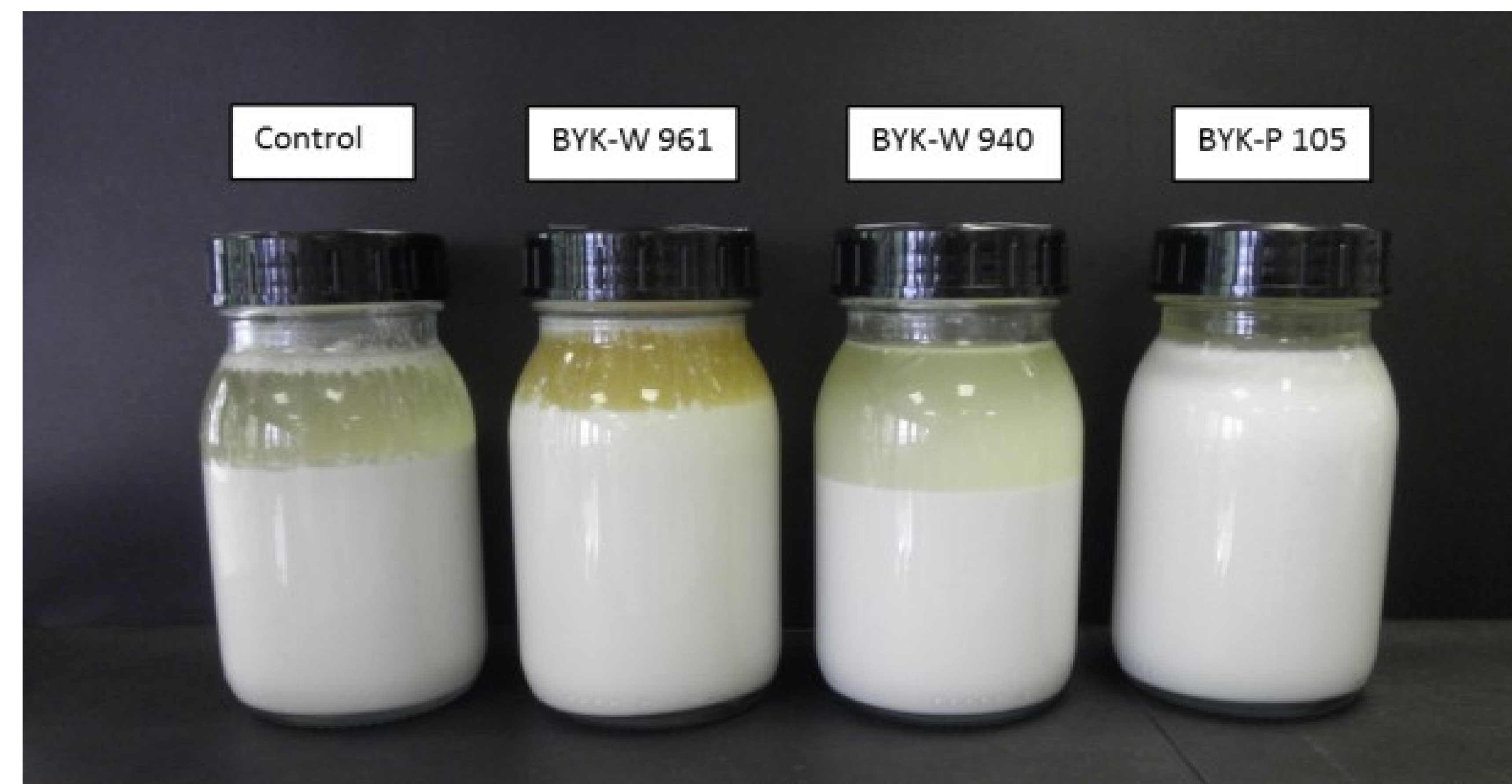
ウレタン系に於けるBYK-P 105の使用 50wt%炭酸カルシウムの沈降防止
