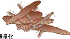
タルクと比較して、少量添加での補強効果が高く、軽量化分散粒径が小さいため、耐傷つき性の向上が図れる
