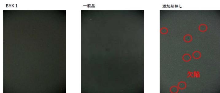
図10 正極電極塗工面の状態
