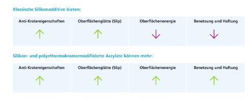
Für Formulierer von Klar- und Decklacken, die seit Jahrzehnten silikonbasierte Additive einsetzen, schafft die Technik hinter <u>BYK-3568</u> komplett neue Möglichkeiten in Bereichen der Überlackierbarkeit und der Haftung, da es **mehrere Effekte mit nur einem Additiv** bietet.
