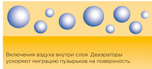
Рисунок 5. Пенoгашение в сравнении с деаэрацией.
