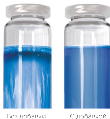
Рисунок 4. Ненасыщенная полиэфирная смола с низкой усадкой (LS) с наполнителем и пигментом.
