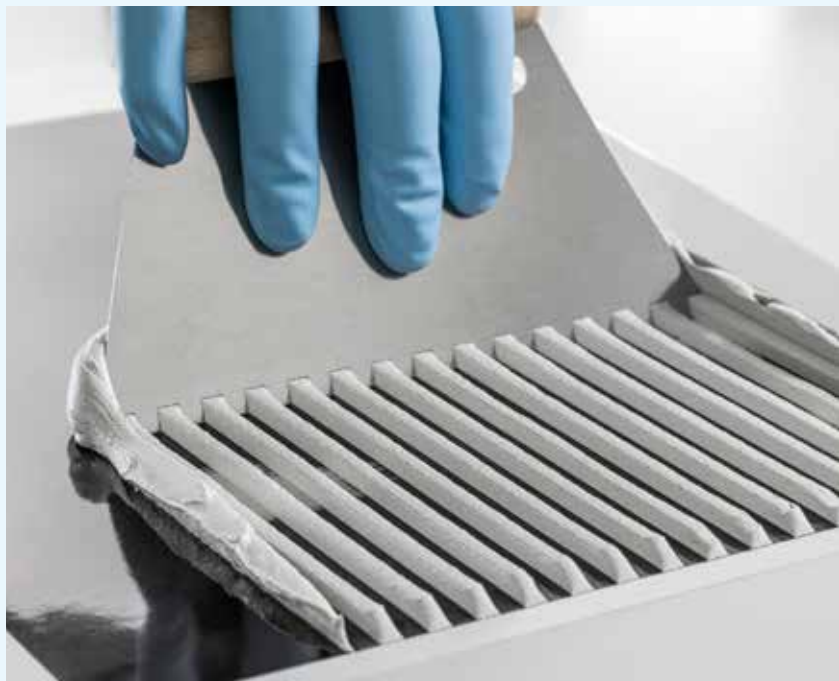
Applikation eines Dickschichtsystems
