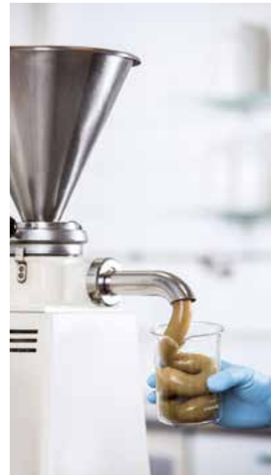
Herstellung einer Schmierfettprobe mit einer Kolloidmühle
