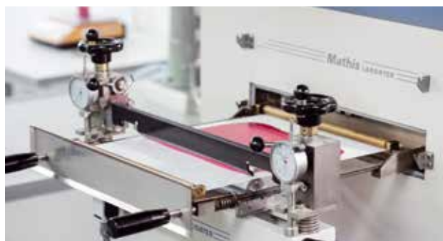
Labortrockner mit Beschichtungsaggregat
