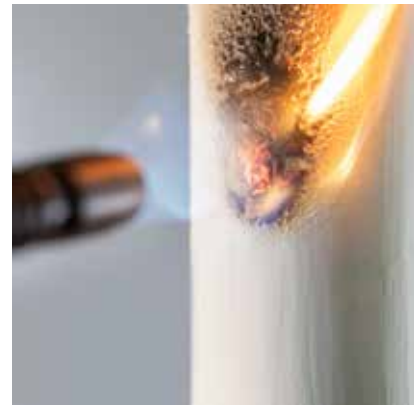
Nachhaltiger Brandschutz durch intumeszierende Beschichtungen
