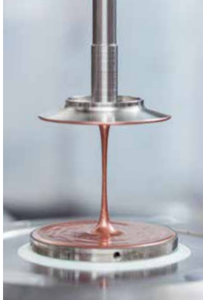
Evaluierung des Fließverhaltens mit einem Rheometer
