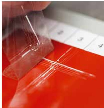
Gitterschnitt zur Bestimmung der Haftung
