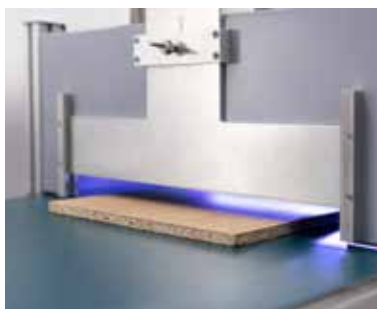
LED-UV-Härtung unter N 2 -Schutzgasatmosphäre
