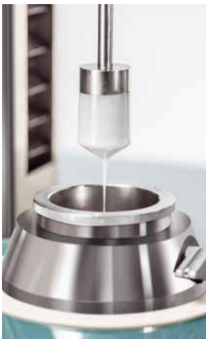
Viskositätsmessung mit einem Zylindersystem
