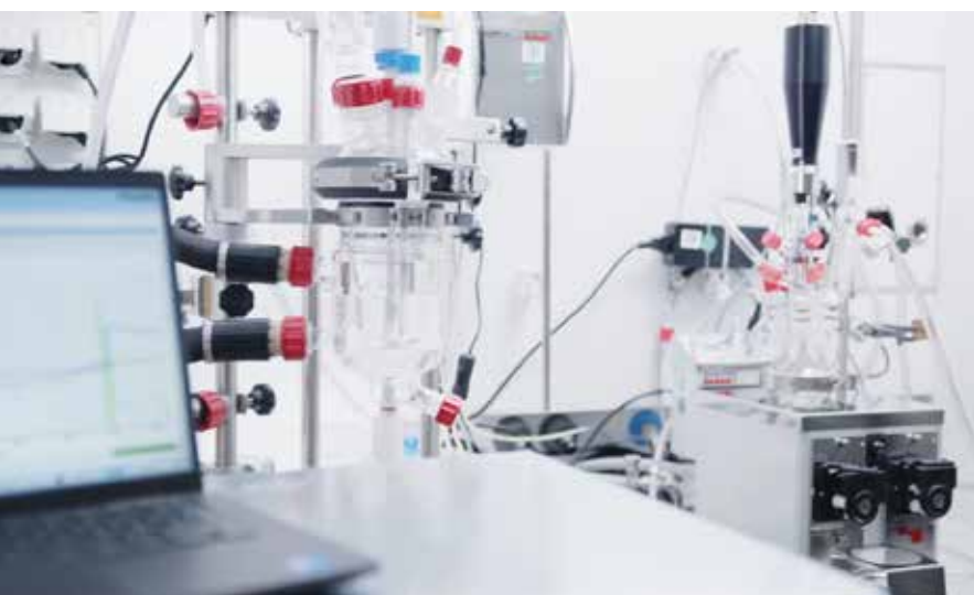
SmartLab: computergestützte vielseitige Reaktoren zur flexiblen Versuchsgestaltung
