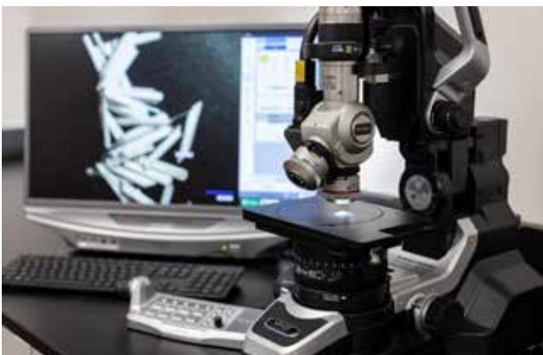
Mikroskop zur Beurteilung von Fasern
