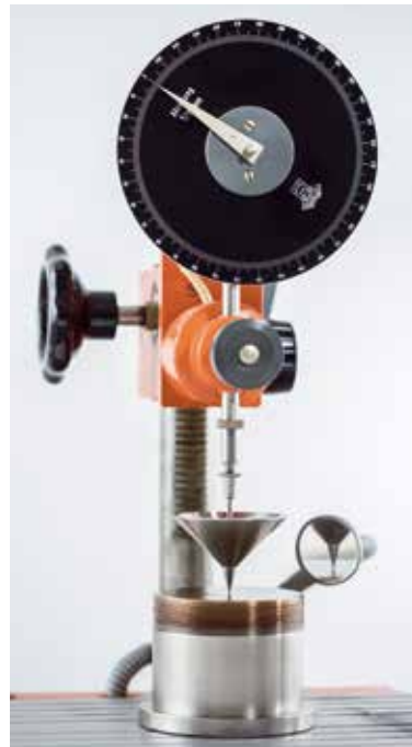
Konsistenzmessung mit einem Penetrometer
