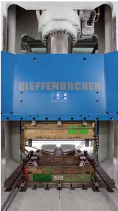
SMC-Pressen mit maximal 1.000 Tonnen Presskraft
