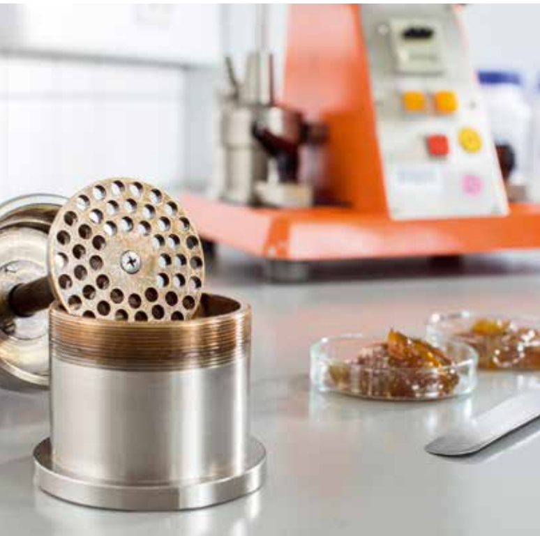
Mechanische Belastung der Probe mit dem Walker
