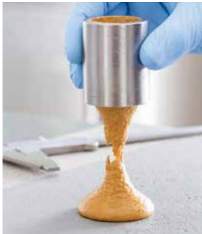
Konsistenzprüfung mit Auslaufzylinder (Flow Cone Test)
