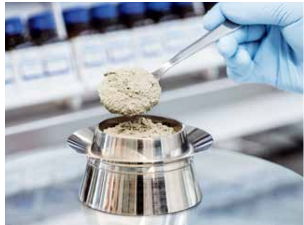
Konsistenzprüfung mit Hägermann-Rütteltisch
