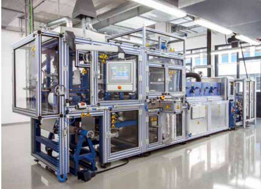
Beschichtungsanlage mit Geliertrommel, Öfen und Kaschierereinrichtung
