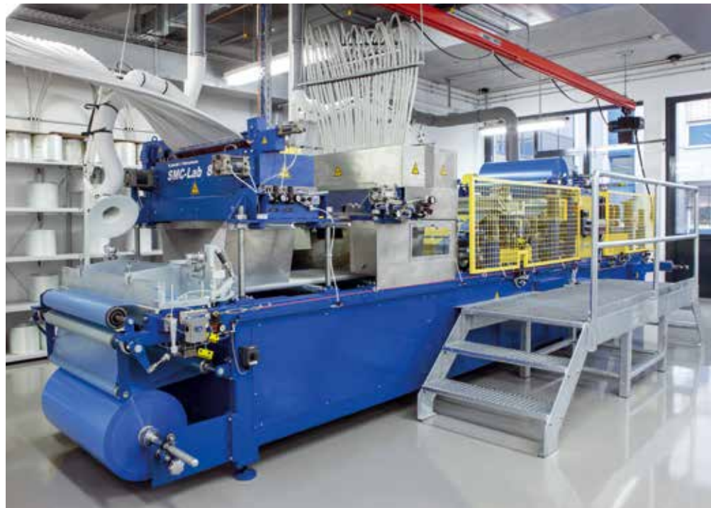
SMC-Anlage mit Glas- und Kohlefaserschneidwerk
