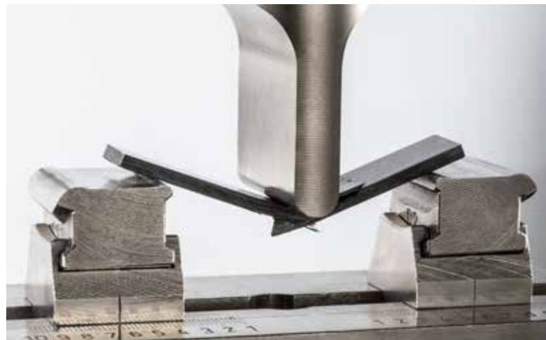
Biegeprüfung eines Probekörpers mit Carbonfasern
