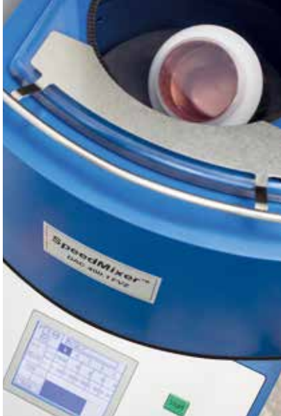
Herstellung von Klebstoffproben
