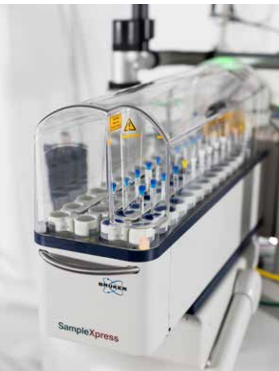
Probenkarussell zur Bestückung des NMR-Gerätes (NMR = Nuclear Magnetic Resonance)
