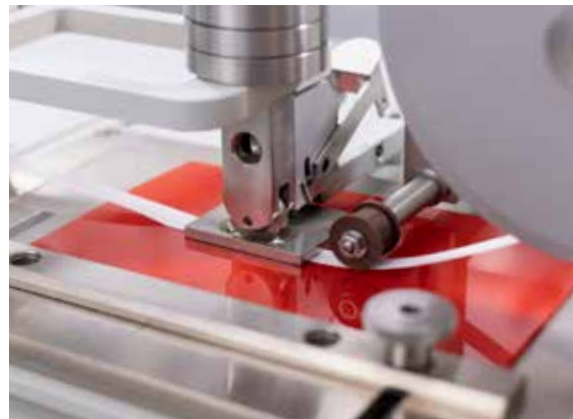
Messung der Abriebfestigkeit
