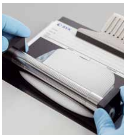
Applikation mit dem Verlaufs rakel
