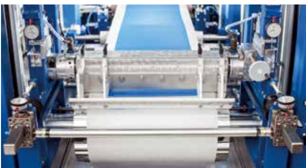
Beschichtungskopf mit optionaler Viskositätsmessung
